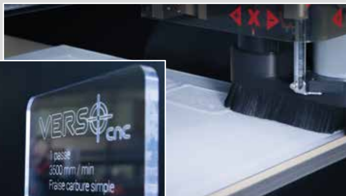
PMMA colado 10 mm 1 pasada - 3.500 mm/min Fresa estándar, sin acabado
