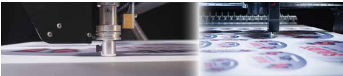
Velocidad adaptativa automática - hasta 74.000 mm/min
