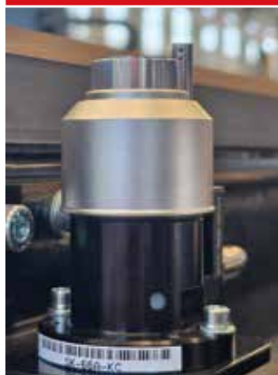
Medição automática do comprimento da ferramenta
