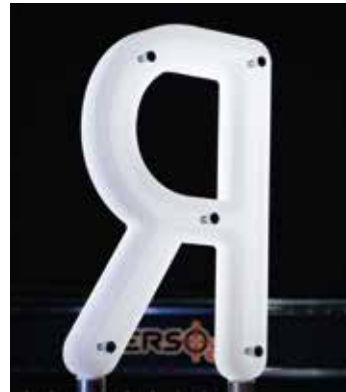
Compensato okoumé 22 mm 1 passata 12.500 mm/min
