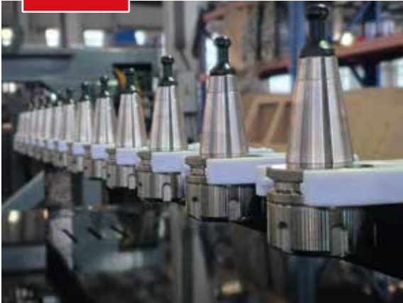
Cambiador automático de 14 posiciones
